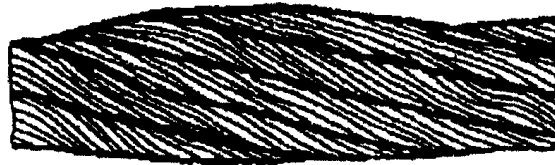
Рисунок 13. Местное увеличение диаметра каната.
